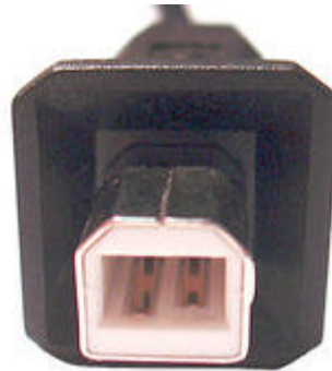
Een USB B-stekker voor aansluiting aan de apparaatzijde
