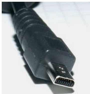
Een mini-USB B-stekker voor aansluiting aan de apparaatzijde
